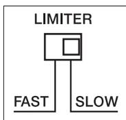
Der eingebaute Limiter zur Vermeidung von Übersteuerungen ist in seiner Zeitkonstante umschaltbar. Normalerweise sollte die Stellung SLOW benutzt werden (Auslieferungszustand).
